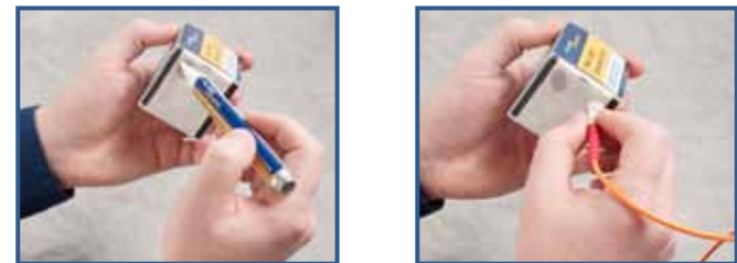
Figura 31 - Metodo di pulizia 'da umido a secco'. Mettere una piccola quantità di solvente nel punto di partenza della passata di pulizia. Tenendo la superficie terminale del connettore perpendicolare, strisciare dalla zona inumidita verso quella asciutta.
